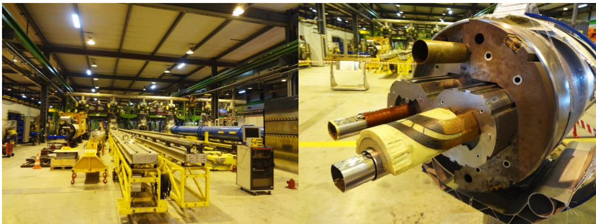
รูปที่ 10: (ซ้าย) เครื่องมือที่ใช้ทดสอบ Superconducting device ภายในสถานี SM18 (ขวา) ภายในท่อของเครื่องเร่ง
