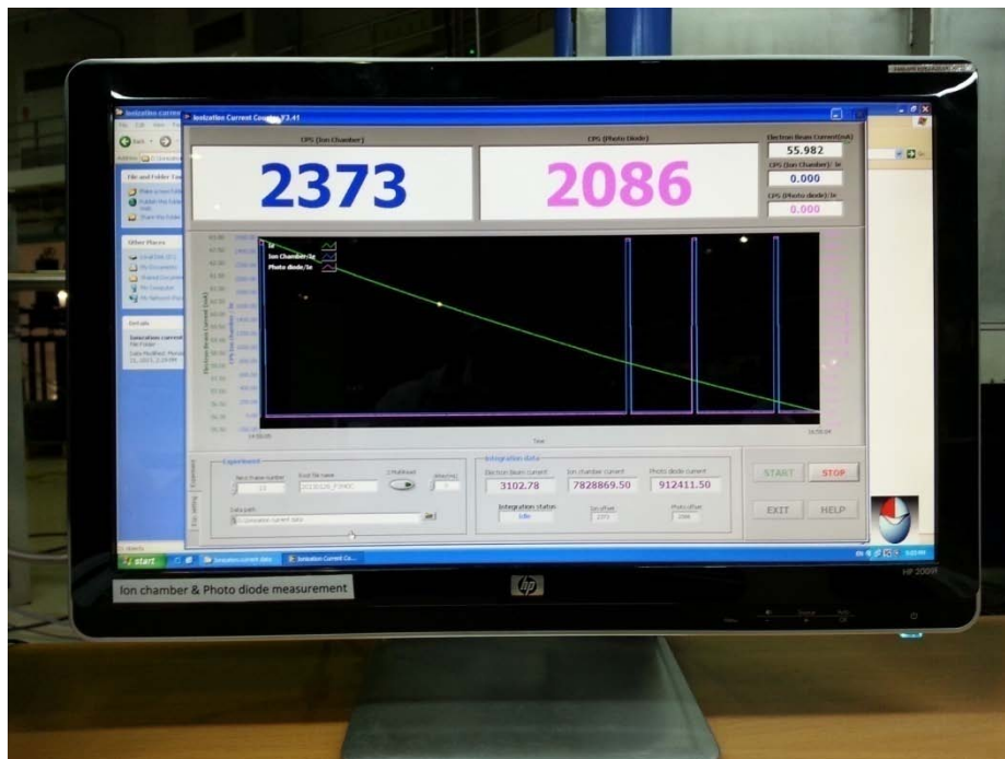
รูป 5.1 จอแสดงค่าความเข้มแสงจาก ionization chamber (ตัวเลขสีน้ำเงิน) และ photodiode (ตัวเลขสีชมพู) แสดงค่า background ขณะที่ปิด beam shutter
