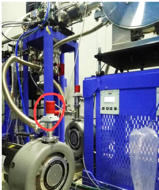
รูปที่ 61 Dry scroll pump ที่ต่อกับ Turbo molecular pump ส่วนระบบ XBPM
