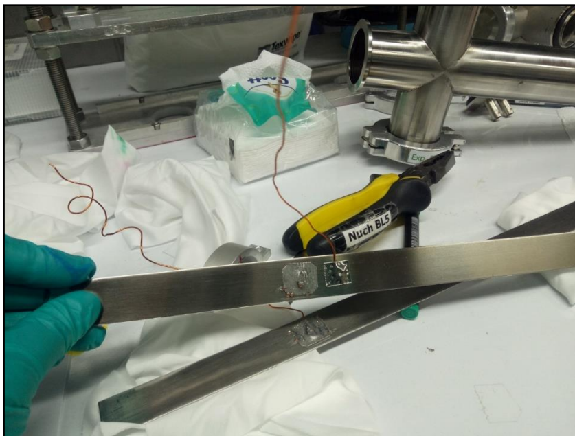
รูปที่ 14 เปลี่ยนเส้นลวดทองแดงที่เชื่อมต่อกับแผ่น Plate ภายในส่วน I 1 Chamber
