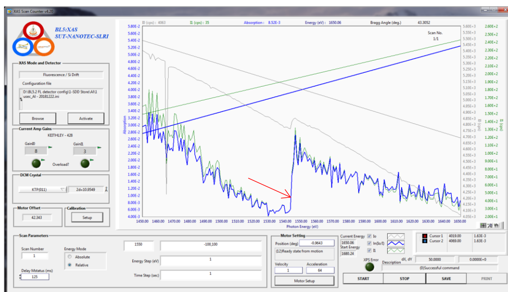
รูปที่ 58 แสดงโปรแกรม XAS Scan ที่วัด Al K-edge ด้วย \text{Al}_2\text{O}_3
