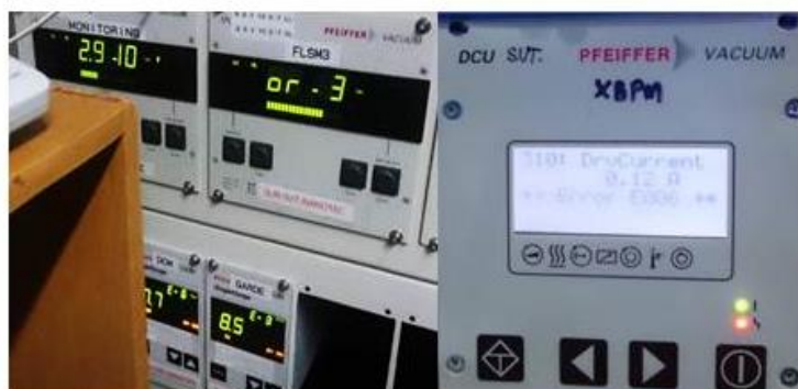
รูปที่ 59 ความดันในส่วน FLSM3 สูงขึ้น เนื่องจากการทำงานไม่ปกติของ ion pump
