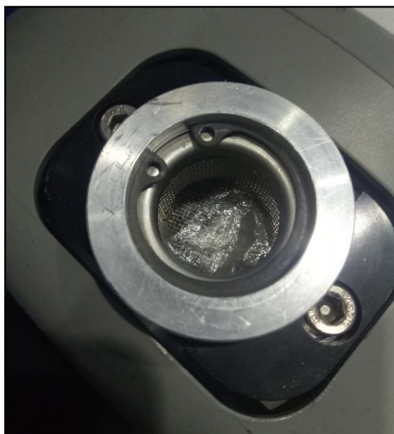
รูปที่ 15 ชิ้นส่วน PP Film ที่ติดอยู่ในท่อของอุปกรณ์ Dry Scroll Pump
