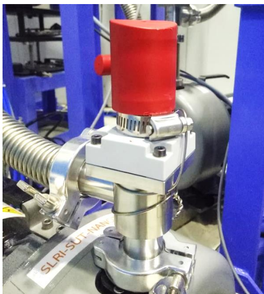
รูปที่ 64 ติดตั้ง clamp lock ที่วาล์วของ Dry scroll pump
