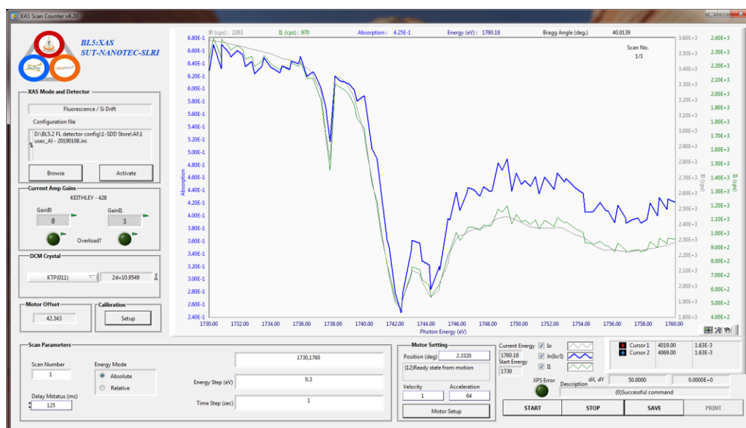
รูปที่ 57 แสดงโปรแกรม XAS Scan ที่วัด Al K-edge ด้วย \text{Al}_2\text{O}_3
