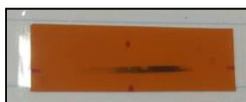
รูปที่ 56 การ Burn paper เป็นเวลา 5 นาทีหลังจากการ Maximize I_0
