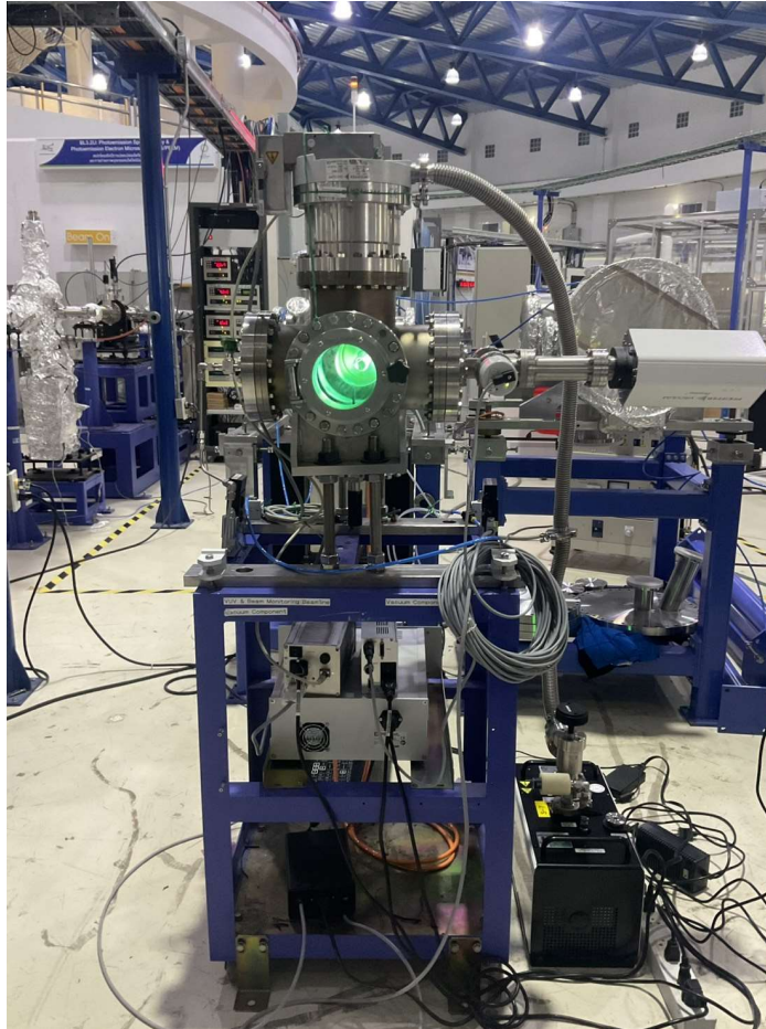
ภาพที่ 4.2 ห้องสุญญากาศ (UV/Ozone Chamber)
