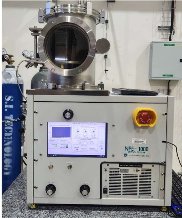
ภาพที่ 4.10 เครื่อง Radio Frequency Plasma Enhanced Chemical Vapor Deposition
