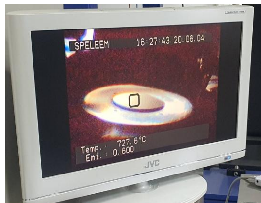
รูปที่ 4 นำ sample holder มาทำการทดสอบกับเครื่อง PEEM
