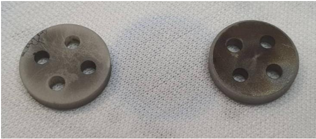
รูปที่ 2 คราบปนเปื้อน (Contaminant) บนพื้นผิวชิ้นส่วนเซรามิกฉนวน
