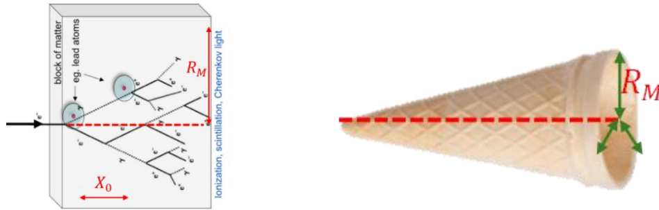
รูปที่ 5 แสดงการกระจายตัวในแนวขวางเมื่ออนุภาคหรือรังสีตกกระทบลงวัสดุกำบัง
