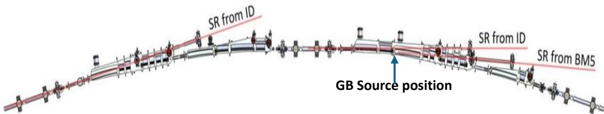
รูปที่ 21 ตำแหน่งของ Bremsstrahlung ของ SPS-II
