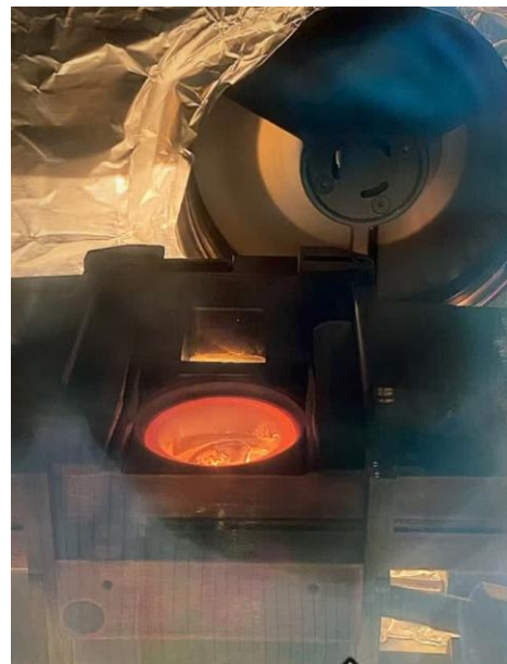
รูปที่ 6 กระบวนการเคลือบ Au บน SUS304 ด้วยเทคนิค Thermal evaporation
