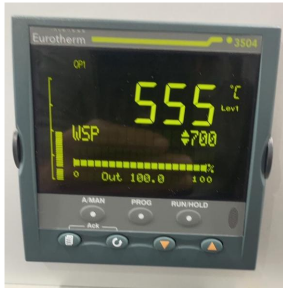
รูปที่ 24 อ่านค่า Temperature ที่ระบบจ่ายให้กับตัวอย่าง
