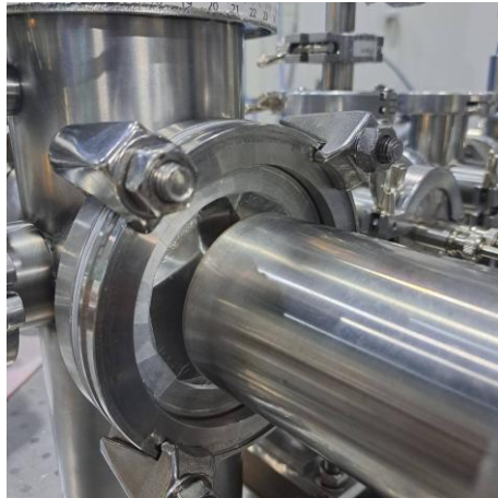
รูปที่ 42 ระยะของ Detector ที่ใกล้ตัวอย่างโดยมี PP window ปิดอยู่ และตำแหน่งบนสเกล
