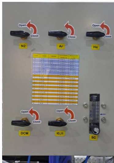
รูปที่ 22 กล่องควบคุมการเปิด-ปิดแก๊สที่ใช้ในสถานีทดลอง
