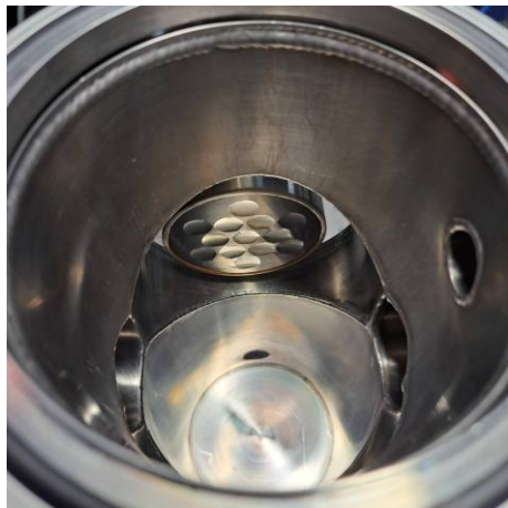
รูปที่ 41 ภาพถ่ายระยะของ Detector ที่ไกลตัวอย่างได้มากที่สุด
