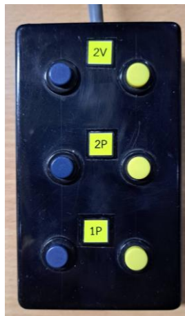
รูปที่ 18 ชุดรีโมทคอนโทรลควบคุมมอเตอร์ในการปรับตำแหน่งผลึกในเครื่อง DCM
