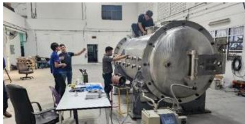
การถ่ายทอดเทคโนโลยีการตรวจสอบหารอยรั่วของห้องสุญญากาศด้วยก๊าซฮีเลียม (Helium Leak Detection) ให้กับภาคอุตสาหกรรม
