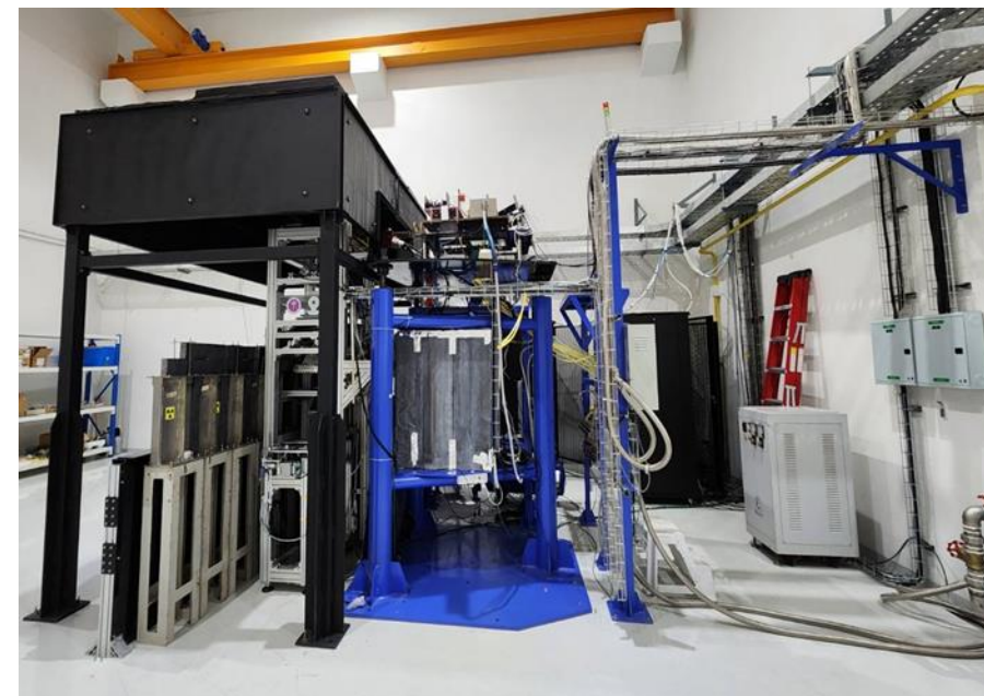
เครื่องเร่งอนุภาคแนวตรงเพื่อรองรับการวิจัยการฉายรังสีบนผลิตภัณฑ์และอุตสาหกรรมเกษตร
