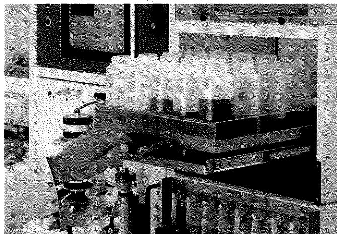
ภาพที่ 2 ภาพ Auto Sampling ของเครื่อง Tiny-TIM
