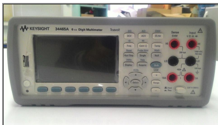
ภาพที่ 4 เครื่อง Digital Multimeter 34465A
