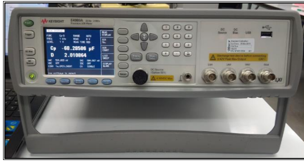
ภาพที่ 6 แสดงเครื่อง Keysight Precision LCR Meter E4980A
