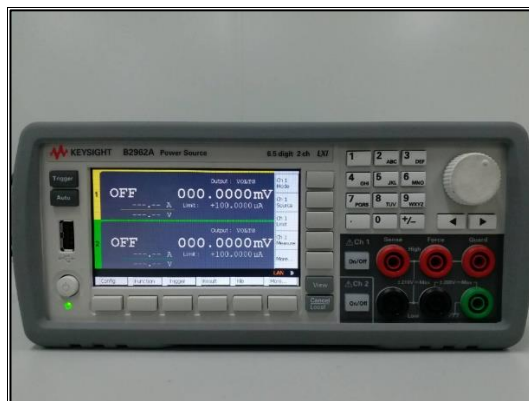
ภาพที่ 7 แสดงเครื่อง Keysight B2962A Power Source
