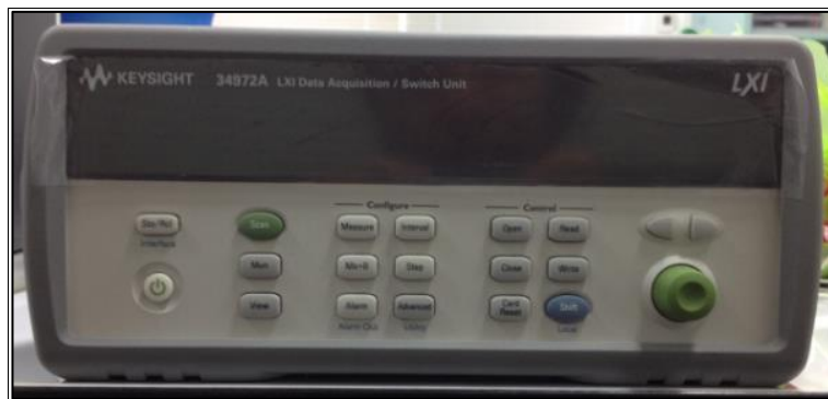
ภาพที่ 5 แสดงเครื่อง Keysight Data Acquisition/Switch Unit 34972A
