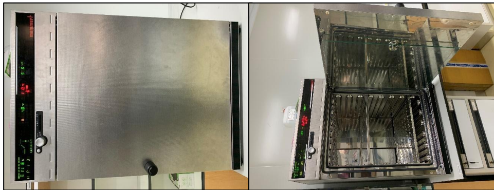
ภาพที่ 10 แสดงเครื่องควบคุมอุณหภูมิและความชื้น
