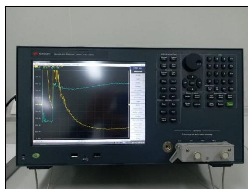
ภาพที่ 9 แสดงเครื่อง Keysight Impedance Analyzer E4990A
