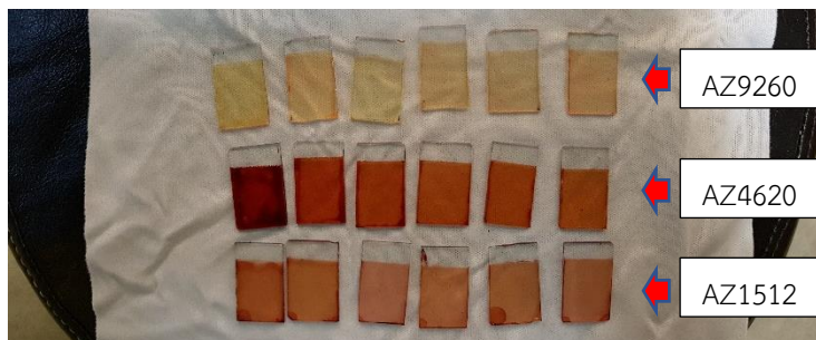
ภาพที่ 5 แสดงตัวอย่างกระจกที่ผ่านการเคลือบด้วยสารไวแสงต่างชนิดกันที่ความเร็วรอบในการหมุนเคลือบต่างกัน
