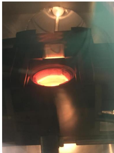
รูปที่ 7 โลหะ Aluminum ที่หลอมละลายที่กระแส 30 mA ขึ้นไป
