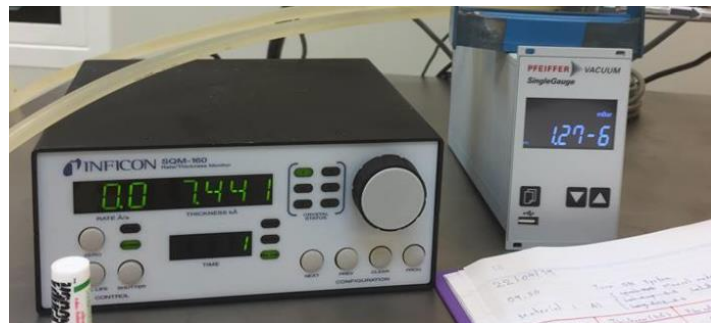
รูปที่ 8 แสดงค่าความหนาที่อ่านได้จากเครื่องวัดความหนา
