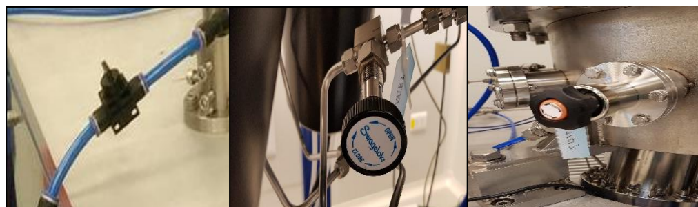
ภาพที่ 13 แสดงที่เปิด-ปิด Shutter
