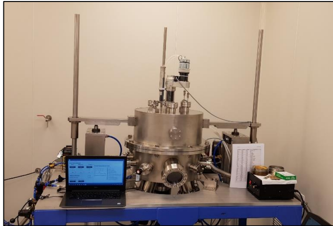
ภาพที่ 1 แสดงเครื่อง DC/RF magnetron sputtering (สปัตเตอร์ริง 3 หัว)
