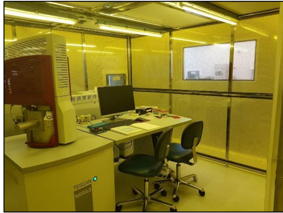
ฉ) เครื่องสร้างลายด้วยกล้องจุลทรรศน์อิเล็กตรอน (Electron beam lithography) และ กล้องจุลทรรศน์อิเล็กตรอนแบบส่องกราดความละเอียดสูง (FE-SEM: TESCAN MIRA3)
