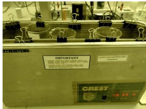
รูปที่ 1 การทำความสะอาดแผ่นแกรไฟต์ด้วย methanol
